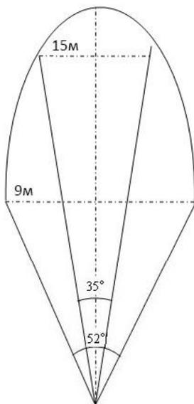
Угол зоны обнаружения ИК датчика ( $\alpha$ ) немного больше угла зоны обзора камеры ( $\beta$ ). Это позволяет избежать пустых снимков и «холостой» работы камеры.
