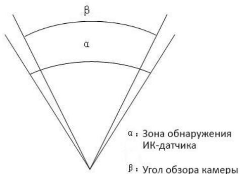
SG880MK использует новую, запатентованную модель ИК датчика движения. Он обладает исключительной дальностью обнаружения. На схеме Вы видите сравнение значений дальности обнаружения стандартного и нового ИК датчиков.
